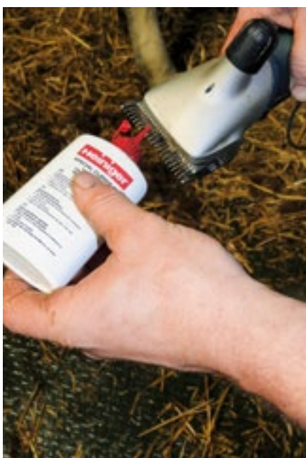
Sehr wichtig ist es, ca. alle Viertelstunde die Messer mit Spezialöl zu versorgen, damit sie nicht trocken laufen.
