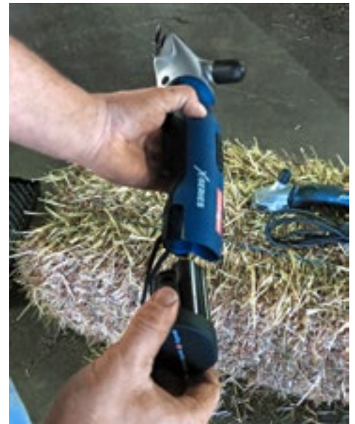
Der sehr kompakte Li-Ion-Akku lässt sich mit einem Handgriff austauschen.
