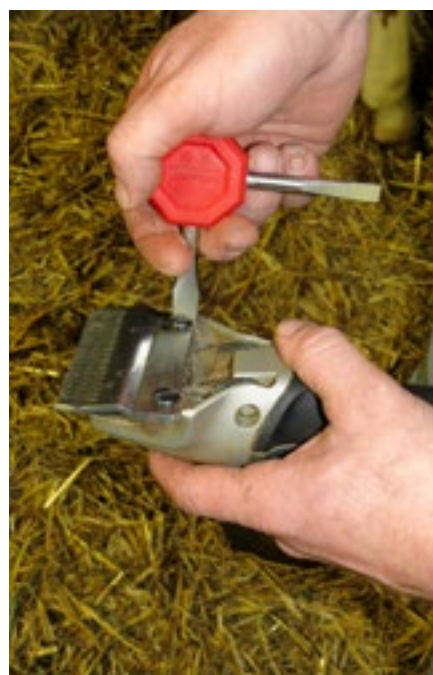
Der Klingenswechsel erfolgt mit dem speziellen Schraubenzieher. Obermesser entspannen, beide Schrauben eine Umdrehung lösen, und beide Messer lassen sich schnell ausbauen.
